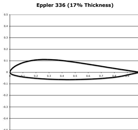
Figure 4.5. *Eppler 336 Airfoil*
